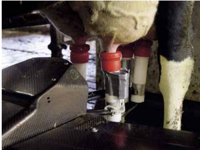
■ Alipainetallentimien avulla voidaan arvioida lypsykoneen asetuksia ja nännikumin sopivuutta.
